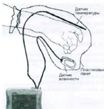
Рис. 17. Схема экспериментальной установки терморегуляции кожи
