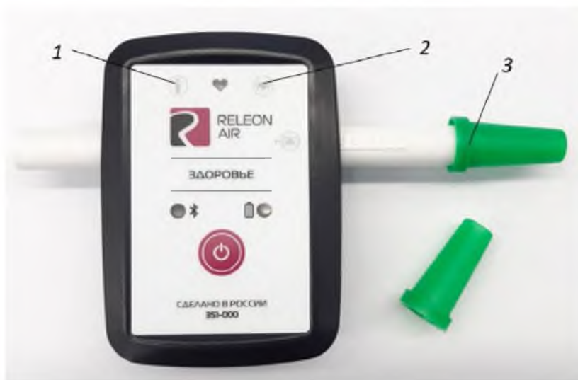
Рис. 3. Мультидатчик по физиологии. Обозначение разъемов и технологических отверстий: 1 — температура тела, 2 — пульс, 3 — частота дыхания (надет съёмный мундштук)
